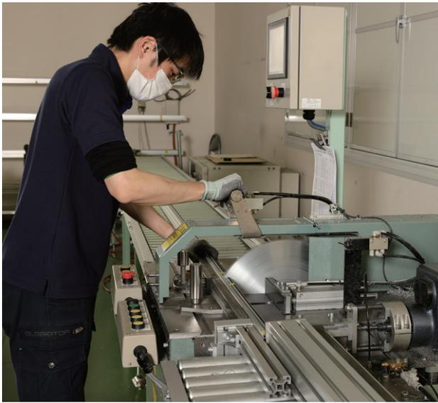
アルミフレームカット機。オーダーメイドなので、指定されたサイズに切断する。フレーム自体も特注品で、オリジナルの金型を使い製造を委託している
