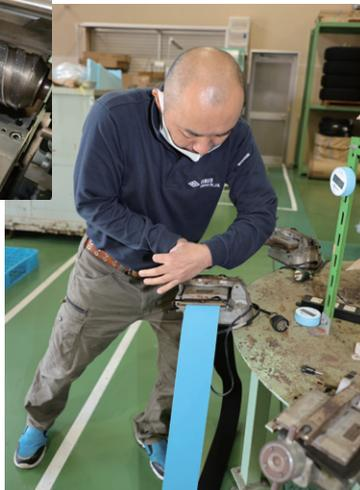
特殊な接着剤を使ってベルトを圧着するエンドレス作業。かつて「ベルトの蒲田工業」といわれた時代からの事業の柱
