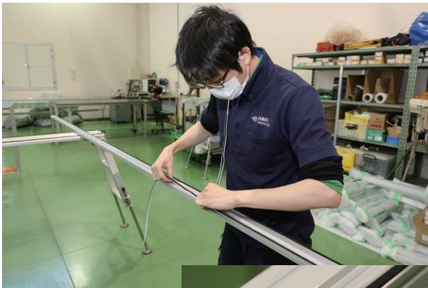
アルミフレームにパッキンを詰める。気密性を確保する上で重要な工程
